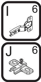
1 - Para montar a porta, encaixe a dobradiça I no calço J travando-a no parafuso indicado com o número 1 abaixo:
